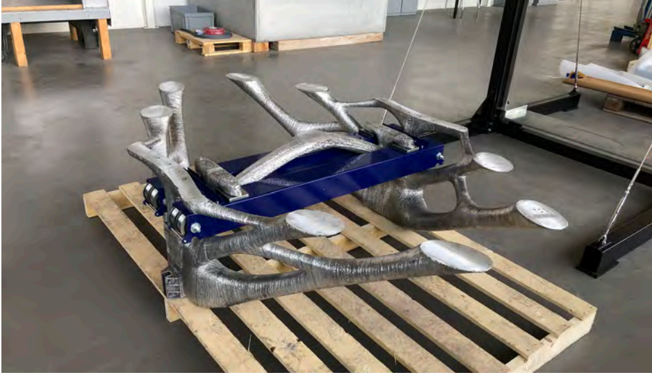
Monte edilmeye hazır zemin yapısı; MX3D'nin izni ile Floor structure ready to be mounted; courtesy of MX3D
